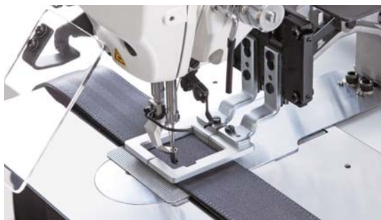
Esempio di applicazione: rinforzo delle cuciture di cinture di sicurezza * La pinza è un articolo da ordinare a parte.
